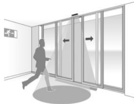
Pengesan cahaya pada pintu automatik
